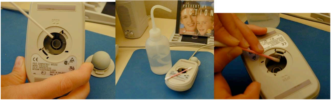
Figure 9 : Insufflation d'air puis nettoyage des capteurs à l'alcool.
