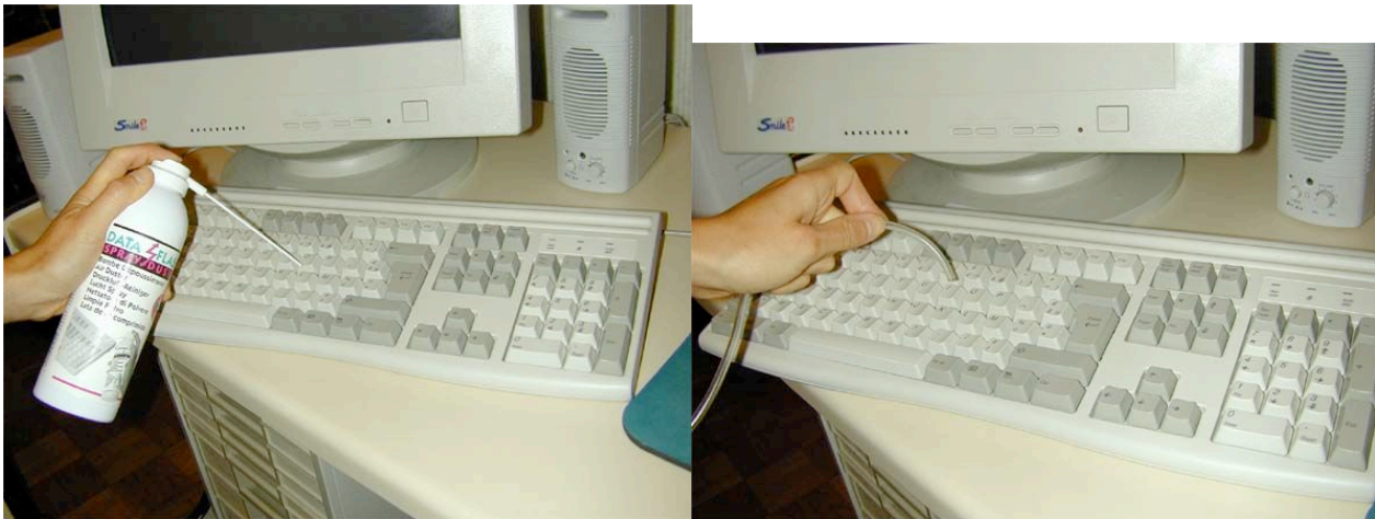
Figure 2 : Nettoyage du clavier, "bombe à air" à G, air comprimé du cabinet à D.
